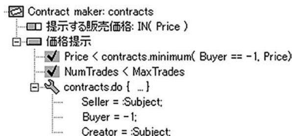
図1 contract creation box を通じた提示価格の入力とそれに伴う処理
