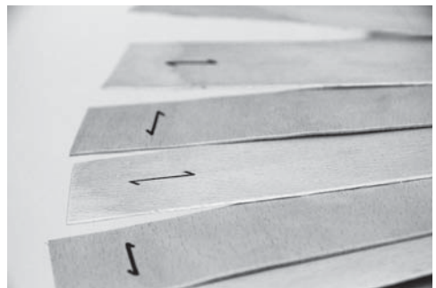
図表12 糊付の方向性（木目を見て方向を交差させることで強度を出す）
