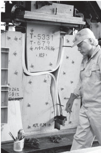
図表 20 ハイバックチェア（圧着前のセッティング）
