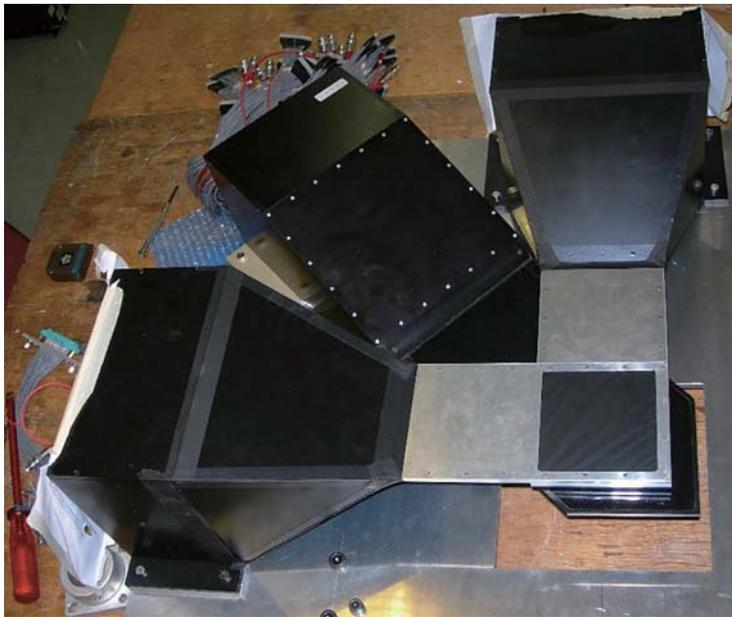
図2 日本グループによって開発された高分解能シンチレーティングファイバーホドスコープ (HRSFD) を組み立てた写真上面の Y、X 2 面が新規に開発した HRSFD で直径 280  $\mu\text{m}$  のシンチレーティングファイバーで作られている。
