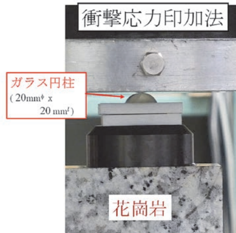
写真5. 花崗岩に負の衝撃圧力を印加する方法。
