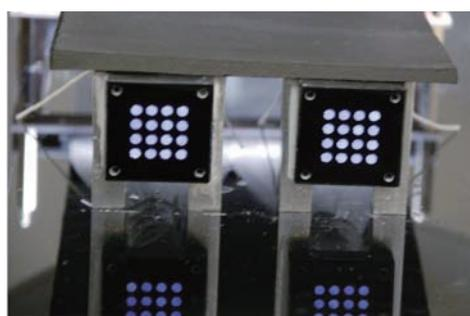
図 3 クリアファイバーの光電子増倍管 (H6568) との接合部分。角穴の直径は 3.1mm で穴同士の距離は 4.5mm である。図はクリアファイバーを CD 研磨用のコンパウンド液で磨いた作業後を撮影したものである。
