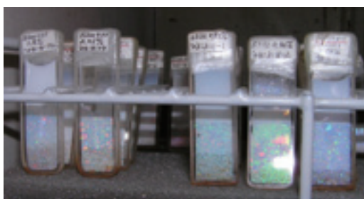
図2 水中でコロイド粒子が周期的に配列し、コロイド結晶を作ると彩虹色を呈する
